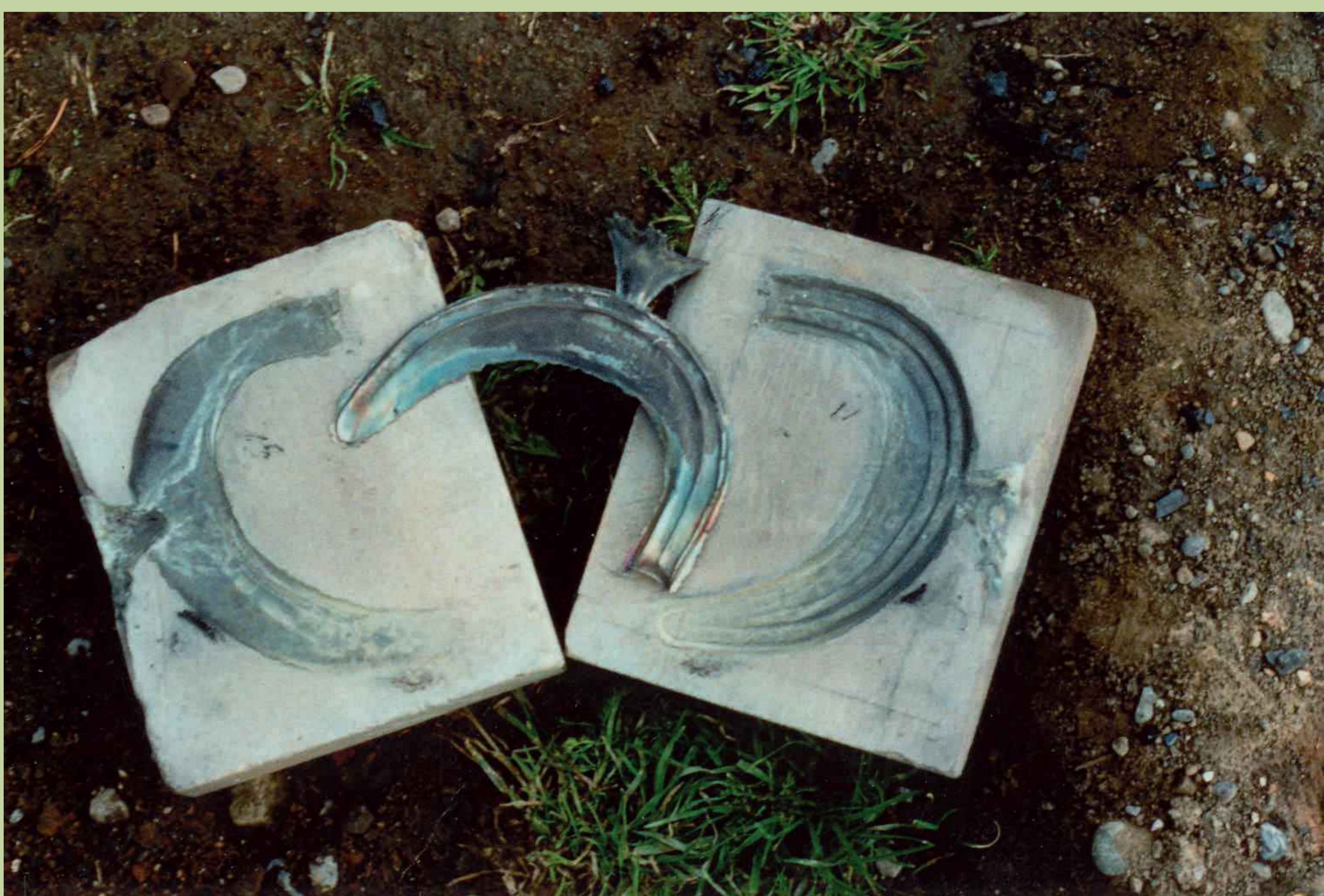
L'objet brut est ensuite sorti du moule et retravaillé.
