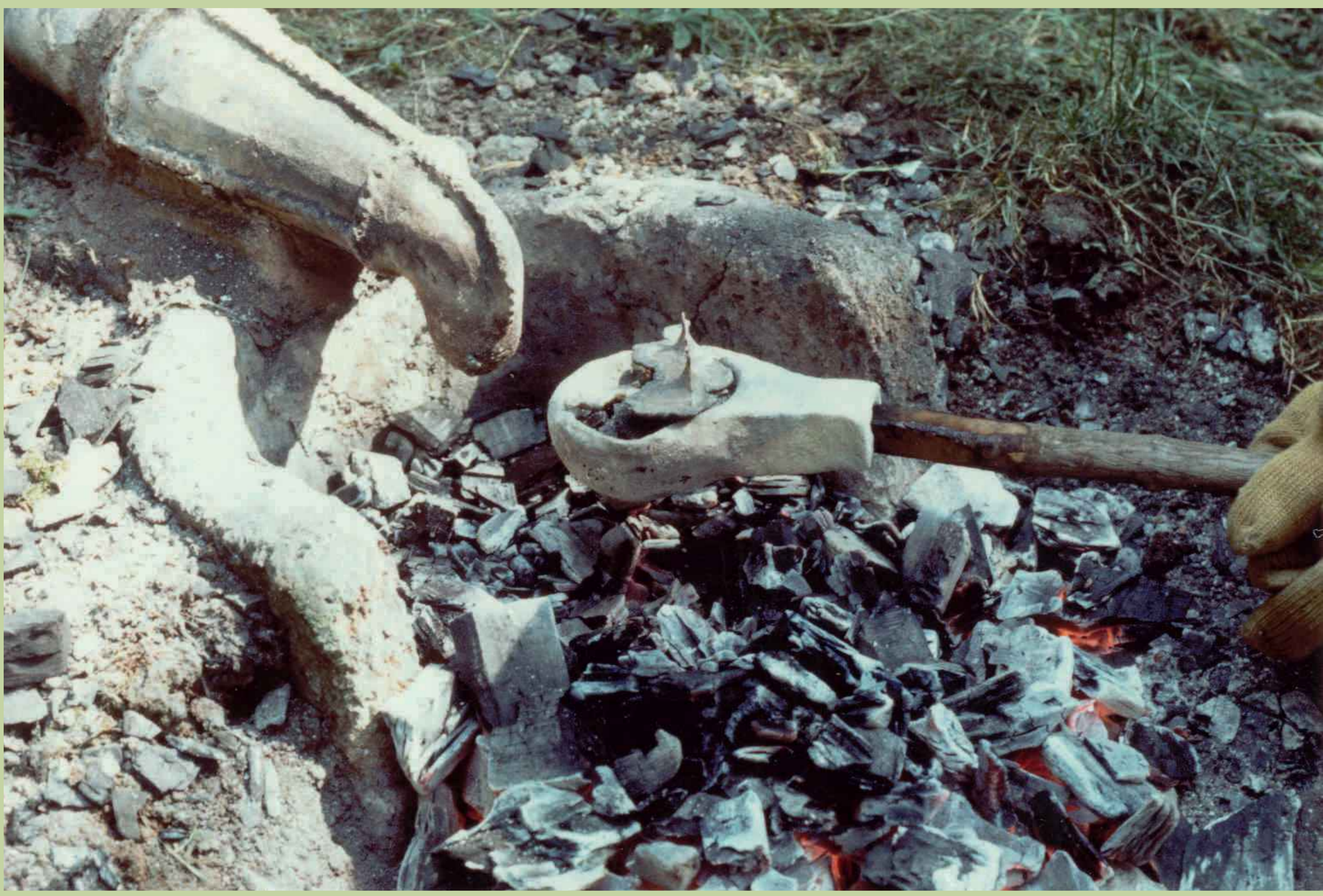
Coulage de bronze expérimental. Le creuset est chauffé au feu de bois. Afin d'atteindre la température de fusion, l'air est acheminé par un soufflet.
